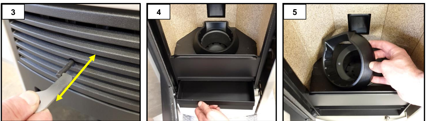
Retirer le diffuseur de flammes comme illustré (fig. 1 et 2)
